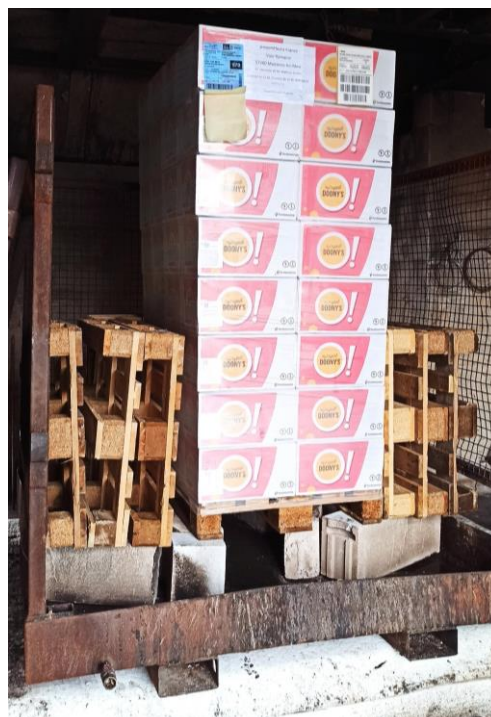
Figure 5-5 : Principe de disposition des foyers calibrés autour de la palette de produits - Essai 3
