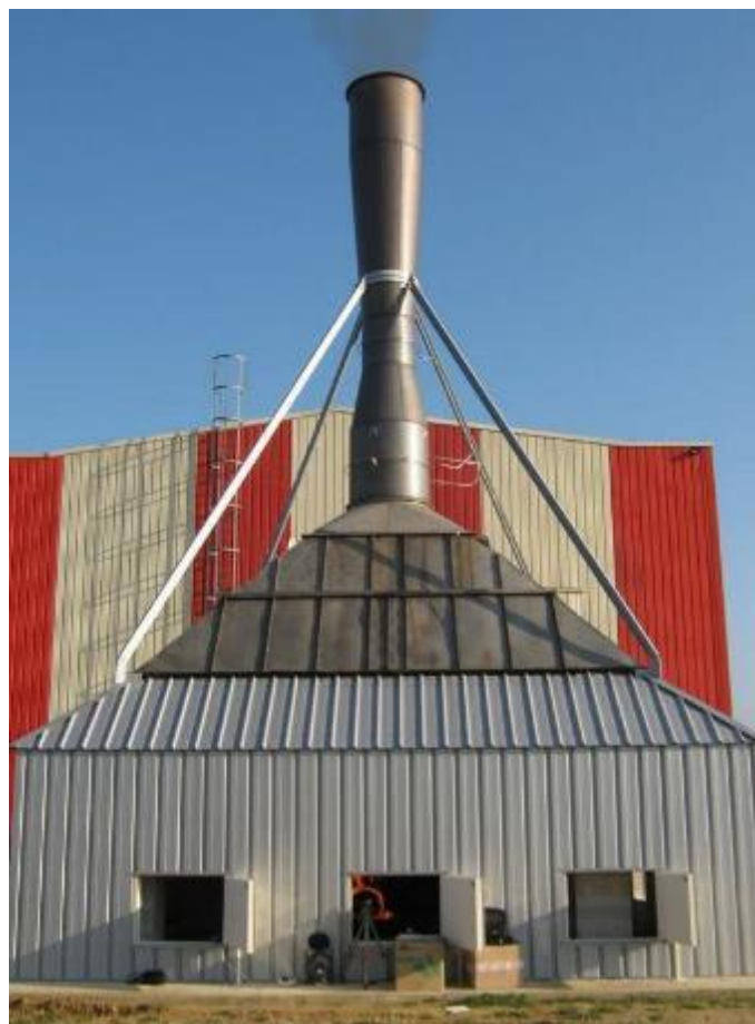
Figure 4-1 : Hotte calorimétrique d'Efectis France à Maizières-lès-Metz (57)
